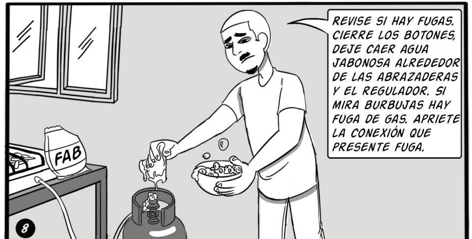
REVISE SI HAY FUGAS. CIERRE LOS BOTONES, DEJE CAER AGUA JABONOSA ALREDEDOR DE LAS ABRAZADERAS Y EL REGULADOR. SI MIRA BURBUJAS HAY FUGA DE GAS. APRIETE LA CONEXIÓN QUE PRESENTE FUGA.
