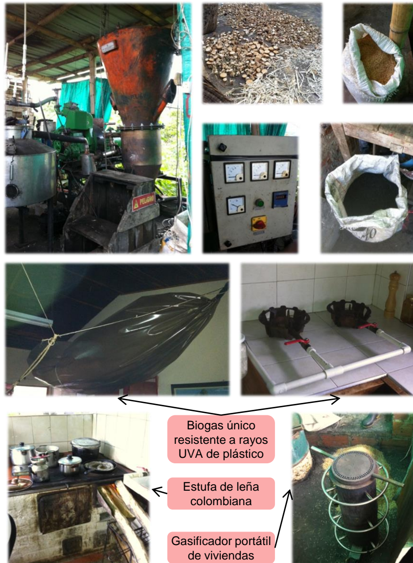
Gasificador de biomasa industrial para las viviendas de agricultores
