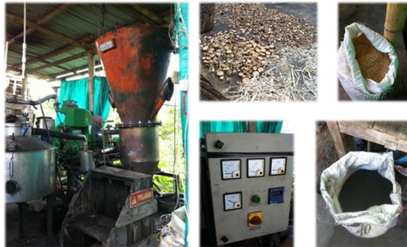
Gasificador de biomasa industrial para las viviendas de agricultores
